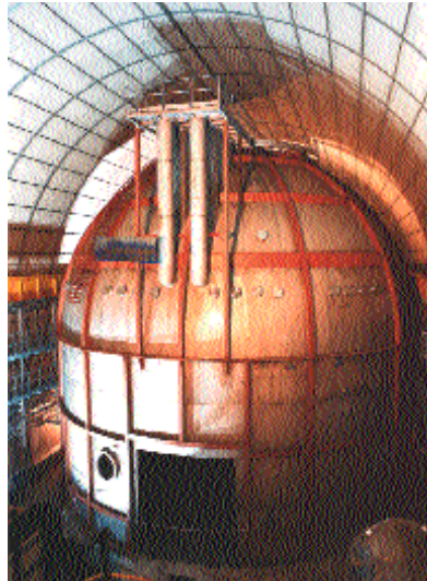
Abb. 5: Das BOREXINO-Experiment im Gran-Sasso-Untergundlabor in Italien. Zu sehen ist der äußere Tank, der das Experiment zusammen mit der Wasserabschirmung enthalten wird. Der Tank ist etwa 20 m hoch. (Borexino wird gefördert durch die BMBF-Verbundforschung)
